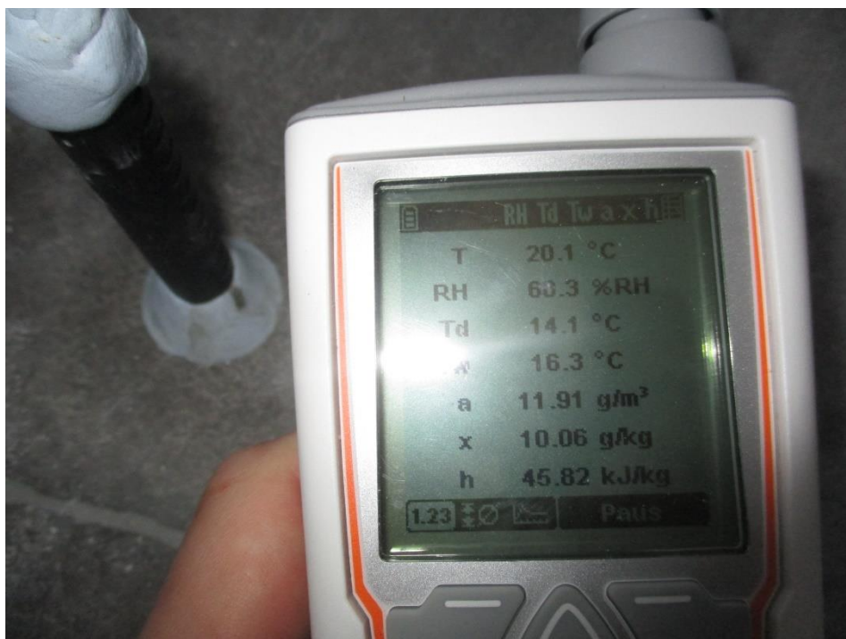
Bild 28: Borrhållsmätning för fuktprofil i betonggolv
