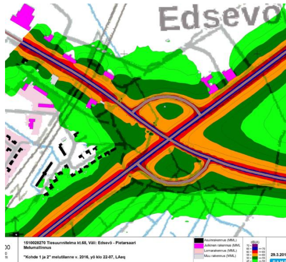
Kuva 10. Kuvassa nykytilanteen melutasot yöllä klo 22-07. Nopeusrajoitus 80 km/h.
