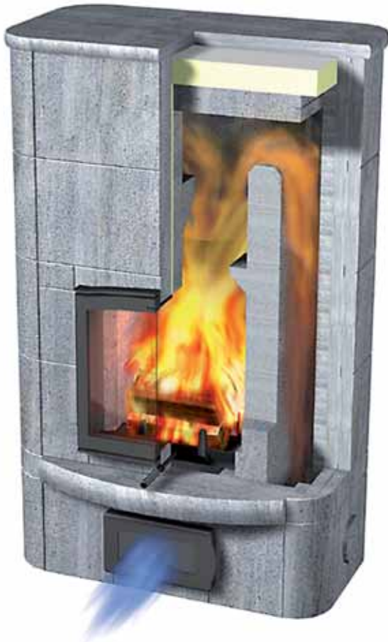
Kuva 3. Kaaviokuva varaavan takan toimintaperiaatteesta (Lähde: NunnaUuni Oy)
