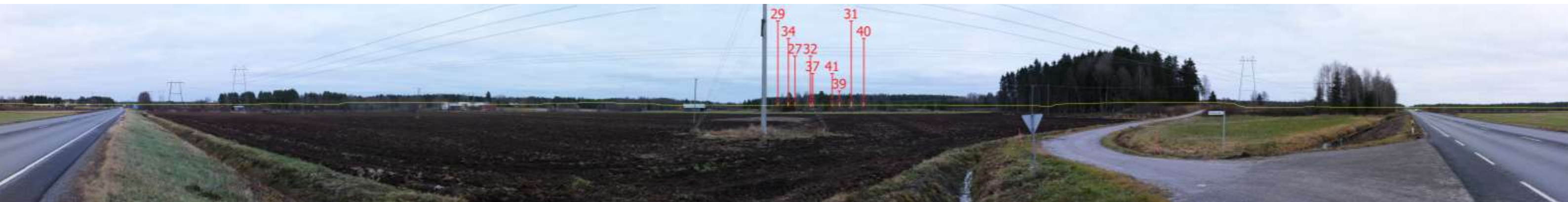
Kuva 21. Valokuvasovite kuvauspisteestä 2 vaihtoehdossa 3 (VE3) on otettu Kovjoen kylästä. Etäisyys lähimpiin voimaloihin on noin 16,1 kilometriä. Voimalat on numeroitu ja roottoriympyrä korostettu punaisella.
