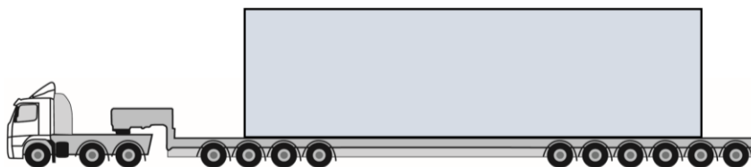
Figur 2: Illustration av en typisk transport av tornelement (inte i skala).
